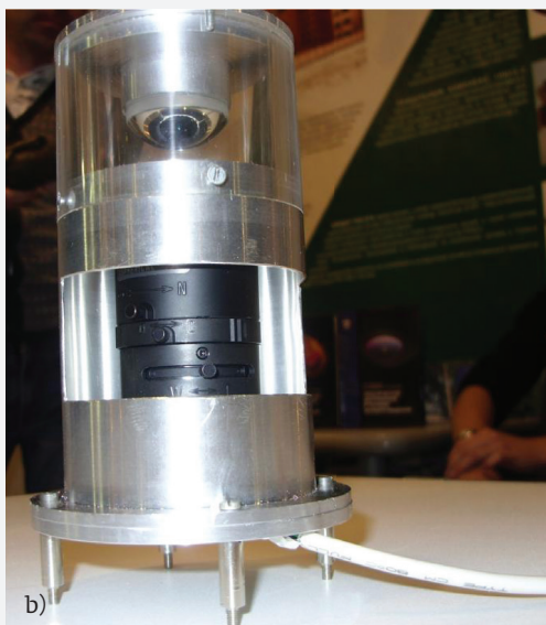
Рис. 3. Вариант телевизионного канала кругового обзора Fig. 3. Option of the television channel with the all-around viewing
