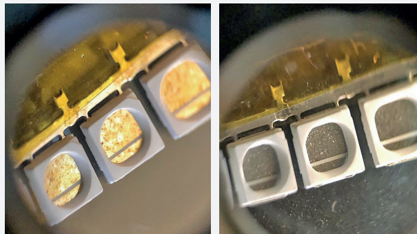
Рис. 2. Рамки металлических светодиодов: а) до плазменной обработки; б) после плазменной обработки Fig. 2. Frames of metal LEDs: a) before plasma treatment; b) after plasma treatment
