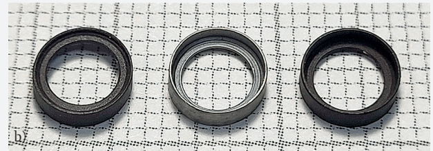
Рис. 2. Диафрагмы ФПУ, оксидированные в разных режимах: а) – образцы диафрагм из стали 07Х17Н16, полученные при выдержке 15 и 20 минут (справа и слева), полученные при выдержке 20 минут в 40-процентном растворе \text{NH}_4\text{NO}_2 с азотно-кислым барием (в центре); б) образцы диафрагм из сплава ВТ6, полученные при выдержке 15 и 20 минут (справа и слева), полученные при выдержке 20 минут в 40-процентном растворе \text{NH}_4\text{NO}_2 с азотно-кислым барием (в центре)
