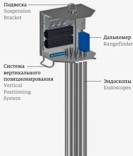
Многоканальный эндоскопический комплекс для осмотра внутренней поверхности направляющих каналов ТВС ВВЭР
