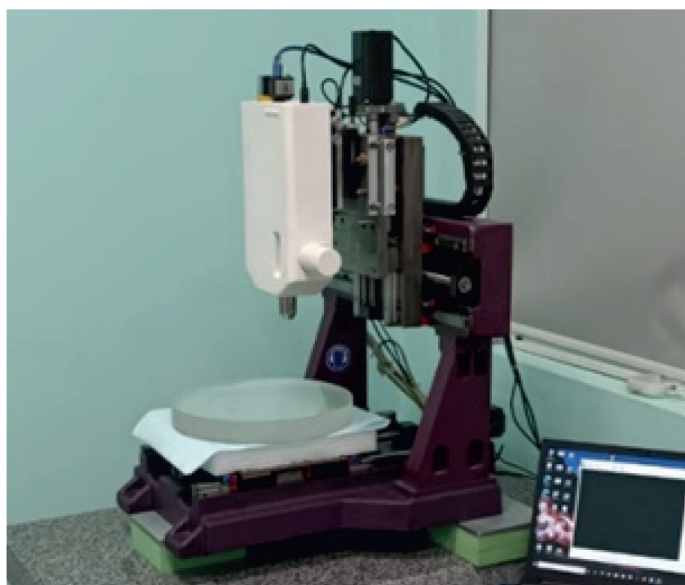
Рис. 4. Внешний вид измерительного комплекса на координатном портале для исследования параметров поверхностей крупногабаритных деталей.
