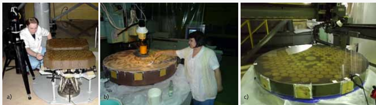
Рис. 17. Пример изготовления и контроля внеосевых оптических элементов: а) контролируемая пара зеркал, юстировка зеркал в схеме контроля; б) обработка метрового зеркала с внеосевой асферической поверхностью с асферичностью в 611 мкм; в) контроль зеркала с внеосевой асферической поверхностью с асферичностью в 611 мкм Fig. 17. Example of fabrication and control of off-axis optical elements: a) controlled pair of mirrors, adjustment of mirrors in the testing circuit; b) processing of a meter-long mirror with an extra-axial aspherical surface and an asphericity of 611 \mu\text{m} ; c) testing of a mirror with an extra-axial aspherical surface and an asphericity of 611 \mu\text{m}
