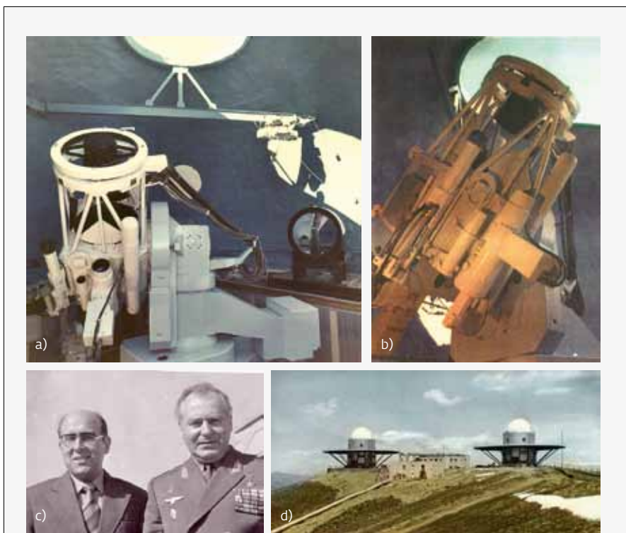
Рис. 1. Квантово-оптическая система «Сириус» (1-я очередь в интересах ГНС «ГЛОНАСС» введена в эксплуатацию в 1980 году; 2-я очередь – в 1985 году): а) телескоп на экваториальной монтировке; б) телескоп на азимутальной монтировке; в) космонавт Герман Титов, генеральный заказчик КОС «Сириус» и В. Д. Шаргородский, генеральный конструктор; д) КОС «Сириус» на горе Майданак, Памиро-Алай, Узбекистан, Н=2700 м Fig. 1. Quantum-optical system “Sirius” (for the benefit of GLONASS GNS, the 1st stage was commissioned in 1980; the 2nd stage was commissioned in 1985): a) a telescope with an equatorial mounting; b) a telescope with an azimuth mounting; c) cosmonaut German Titov, general customer of the Sirius QOS and V. D. Shargorodsky, general designer; d) Sirius QOS on Maidanak Mountain, Pamir-Alai, Uzbekistan, H=2700 m
