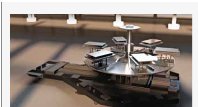
Рис. 9. Карусельный стол с декартовой системой координат технологии MoldJet (источник Tritone Technologies [10])
