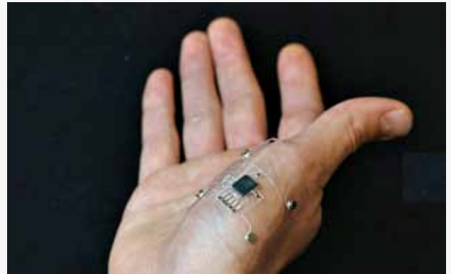
Рис. 14. Компонент носимой электроники, полностью напечатанный на 3d-принтере, способный принимать форму тела человека или животного (Hansjörg Wyss Institute for Biologically Inspired Engineering at Harvard University [17])
