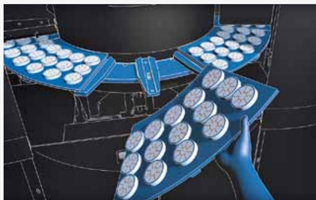
Рис. 12. Визуализация замены секции роторного стола технологии HSR, которая может осуществляться как человеком, так и ПТК, компания dp Polar GmbH [15]
