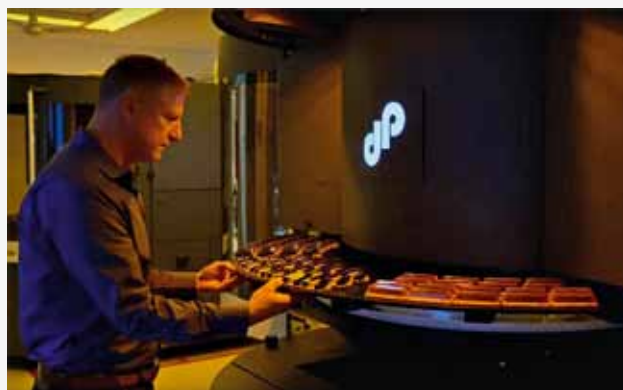
Рис. 11. Процедура замены секции 3d-принтера AMpolar с полярной системой координат, компания dp Polar GmbH [15]
