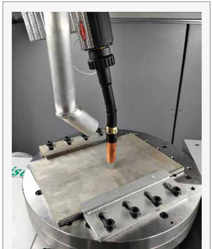
Рис. 6. Круглый поворотный стол на 3d-принтере Gefertec arc405, технология 3DMP/WAAM, компания Gefertec GmbH [4]
