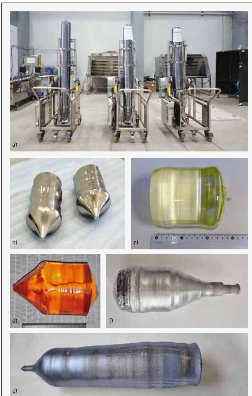
Рис. 4. Монокристаллы: а) монокристаллы кремния, CCz, \varnothing 200 мм (Источник: «Солар системз»); б) монокристаллы германия, Cz, \varnothing 100 мм (Источник: «ОКБ «Астрон»); в) ниобат лития, д) лантангаллиевый силикат, Cz (Источник: «Фомос материалс»); е) монокристалл GaAs, LEC, (Источник: Гиредмет); ф) монокристалл InAs, LEC (Источник: Гиредмет)
