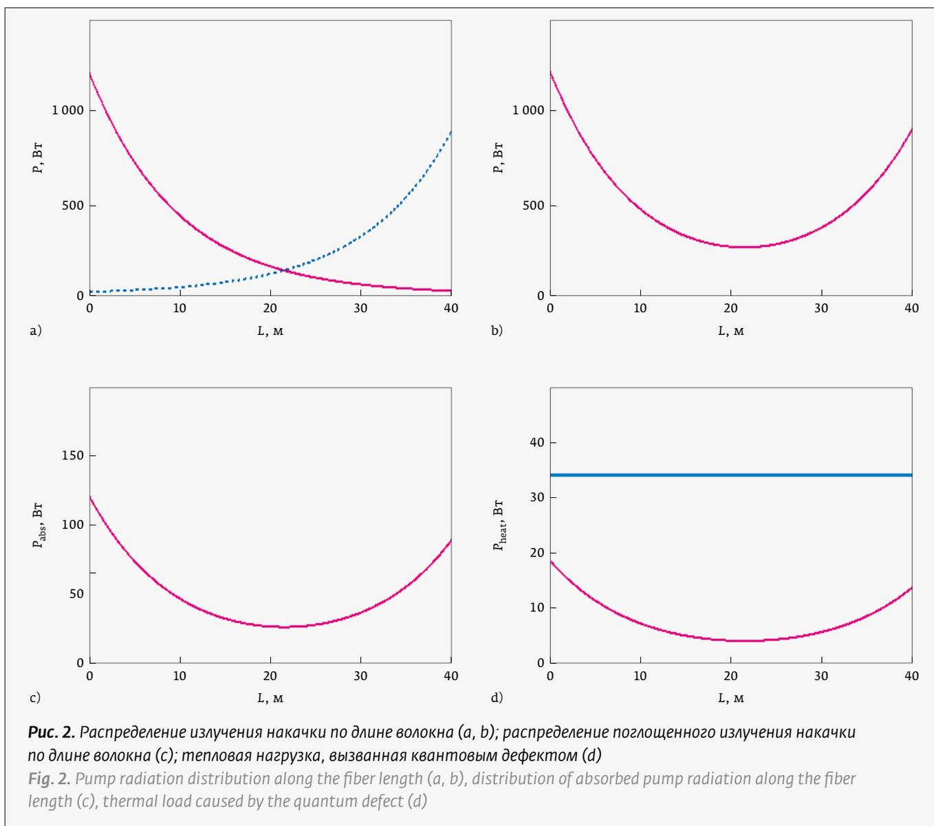
длина оптического тракта волокна с диаметром поля моды 18 мкм для достижения лазерной мощности 1500 Вт не должна превышать примерного значения в 47 м.
