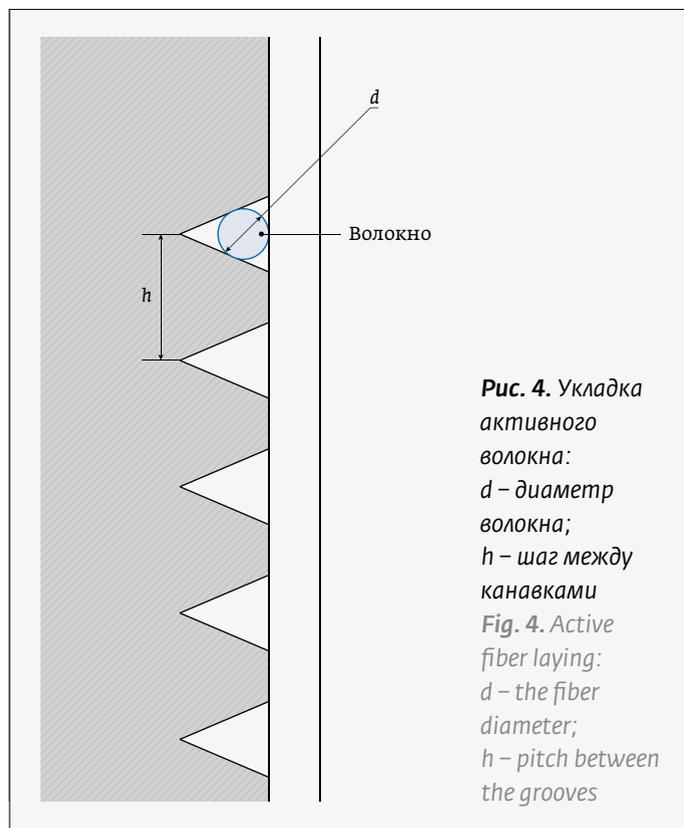
**Рис. 4.** Укладка активного волокна:  $d$  – диаметр волокна;  $h$  – шаг между канавками
