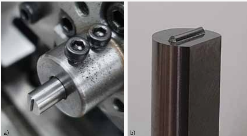
Рис. 14. Обработанный пуансон на станке (a) и готовый пуансон после изготовления обнижений (b)
