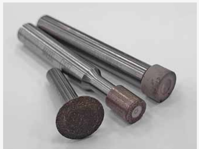
Рис. 8. Абразивный инструмент (слева направо: правильный круг, черновая шлифовальная головка, чистовая шлифовальная головка).
