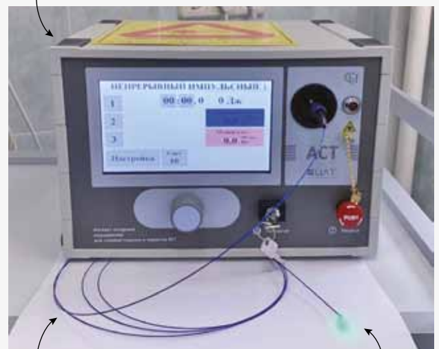
Радиальное оптическое волокно, диаметр 800 мкм Radial optical fiber, diameter 800 microns
