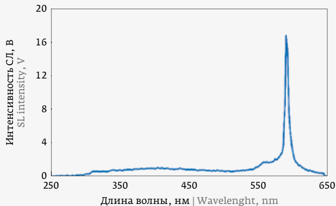
Рис. 3. Спектр и контрастированная фотография СЛ водного раствора 2М NaCl в дальнем УЗ-поле ( W=20 Вт; экспозиция – 8 с)
