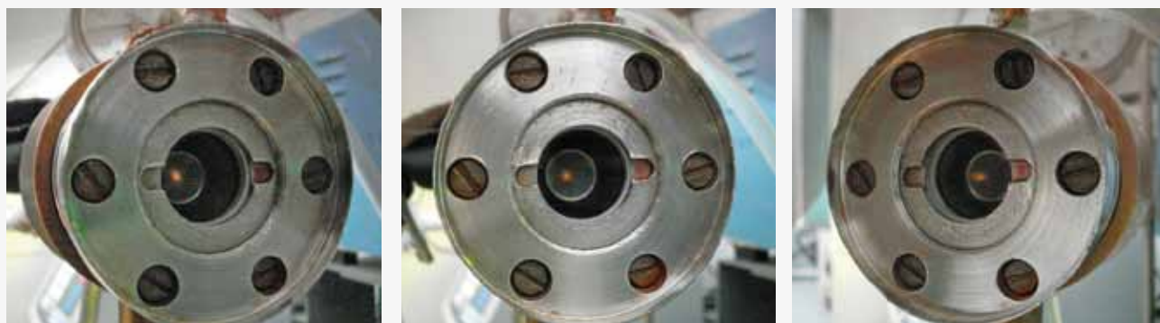
Рис. 2. Фотографии СЛ водного раствора 5М NaCl в ближнем УЗ-поле ( W=36 Вт; экспозиция 8 с)
