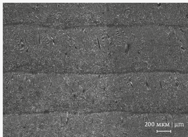
Рис. 2. Исходная микроструктура сплава Inconel 718 после аддитивного процесса прямого лазерного выращивания
