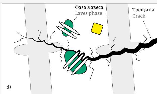
Рис. 5. Схематическое изображения распространения трещины в аддитивно сформированном сплаве Inconel 718 после применения дополнительной термической обработки: продольная ориентация (а); поперечная ориентация (b) Fig. 5. Schematic representation of crack propagation in the additively formed Inconel 718 alloy after heat treatment: longitudinal orientation (a); transverse orientation (b)
