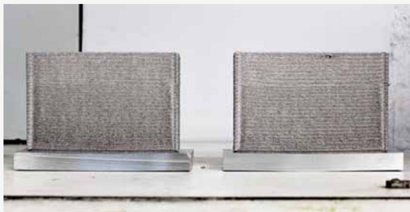
Рис. 2.5. Образцы для механических испытаний из порошка AlSi10Mg Fig. 2.5. Samples for mechanical tests from AlSi10Mg powder
