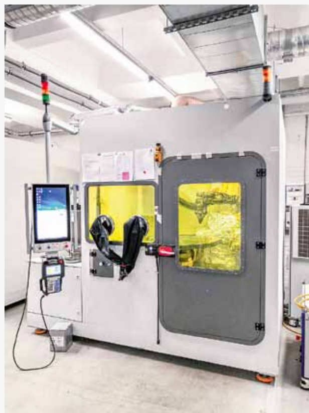
Рис. 1.1. Роботизированный технологический комплекс «ИЛИСТ-Л»
