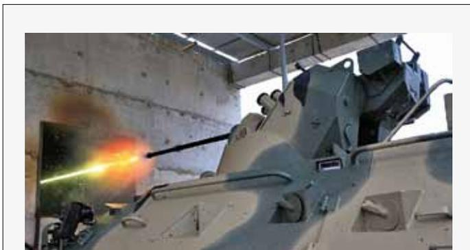
**Рис. 14.** БТР-82А. Стендовая отработка при стрельбе из изделия 2А72
