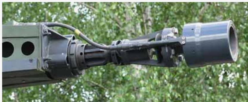
**Рис. 11.** Надульное устройство в составе комплекса вооружения БМП «Пума»
