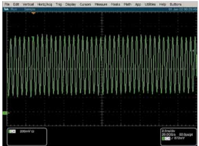
Рис. 9. Полностью синхронизованные моды со стеклом «Конашима»
