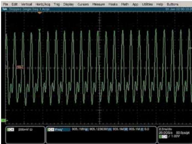
Рис. 8. Частичная синхронизация мод, при мощности накачки 3,5 А на длине резонатора 17 см
