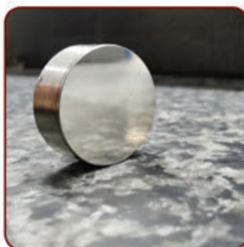
Материал: Титан Обработка: Шлифование/полирование Ra = 0,036 мкм
