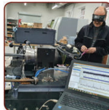
Процесс тестирования вибрационных характеристик станка
