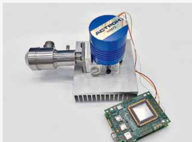
Рис. 2. Микрокриогенная система MKS500, интегрированная с фотоприемным модулем
