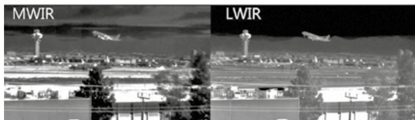
Рис. 9. Изображения, полученные в средне- и длинноволновом диапазоне с помощью МФПУ формата 1280 × 720 с шагом 12 мкм фирмы HRL (США) Fig. 9. Medium and long wavelength images using an APD of 1280 × 720 format with a pitch of 12 μm by HRL (USA)
