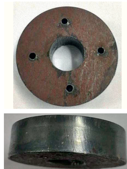
Рис. 4. Углеродистая сталь, толщина 20 мм, отверстия 5 мм
