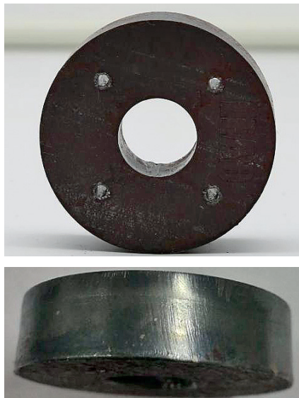
Рис. 3. Углеродистая сталь, толщина 16 мм, отверстия диаметром 3 мм
