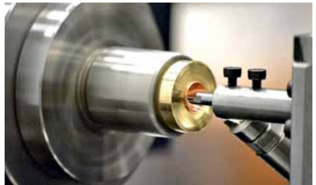
Рис. 5. Обработка внутренней сферической поверхности алмазным резцом
