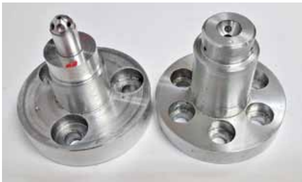
Рис. 4. Оснастка для закрепления детали на станке
