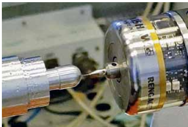
Рис. 2. Процесс обмера щупом обработанной поверхности
