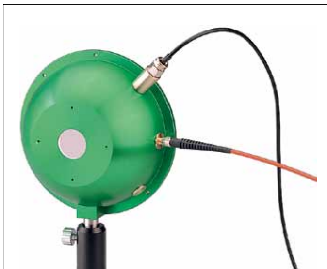
Рис.5. Комбинация сферы с фотодиодом и оптоволоконным портом
