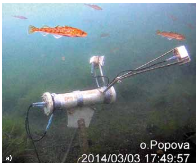
Рис.1. Постановочная рама с флуориметром и лазерным измерителем вариаций гидросферного давления (вид с системы подводного видео мониторинга: а) флуориметр – сверху, лазерный измеритель вариаций гидросферного давления – внизу); б) на заднем плане – второй лазерный измеритель вариаций гидросферного давления
