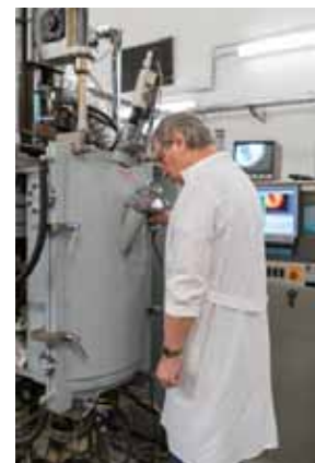
Рис.4. Схема метода выращивания кристаллов по Чохральскому и установка АО "Гиредмет", реализующая метод
