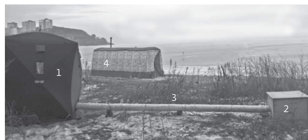
Рис.1. Береговой пункт наблюдения: 1 – помещение основного интерференционного узла мобильного лазерного деформографа; 2 – бокс отражателя; 3 – лучевод; 4 – лабораторное помещение
