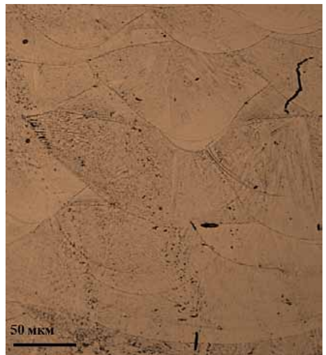
Рис.2. Схема процесса СЛС [6] и изображение ванн расплава Fig. 2. Scheme of the SLS process [6] and molten pools
