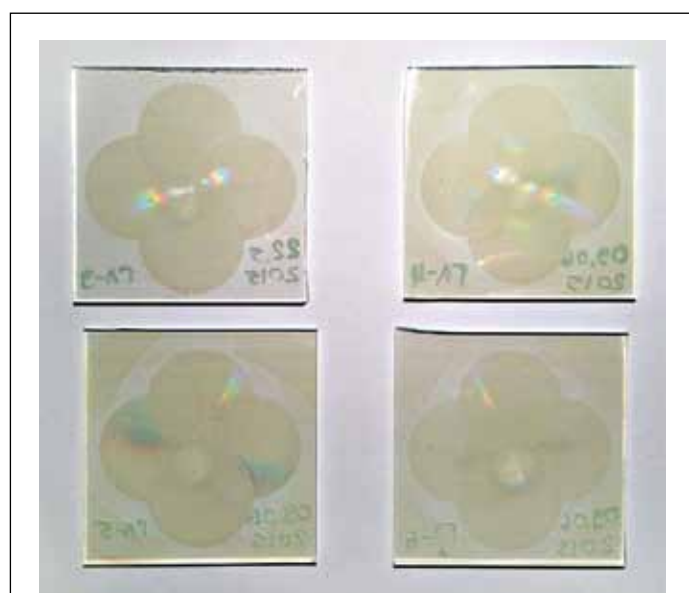
Рис.7. Образцы составной голограммной линзы Fig. 7. Samples of the composite hologram lens
