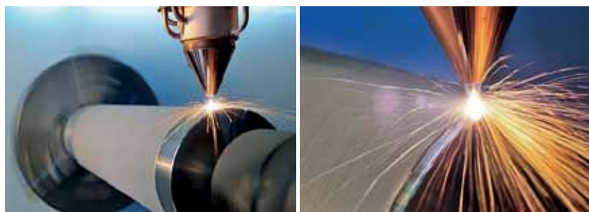
Покрытие поршня с помощью технологии экстремальной высокоскоростной лазерной наплавки (источник: Институт Fraunhofer ILT, Ахен, Германия)
