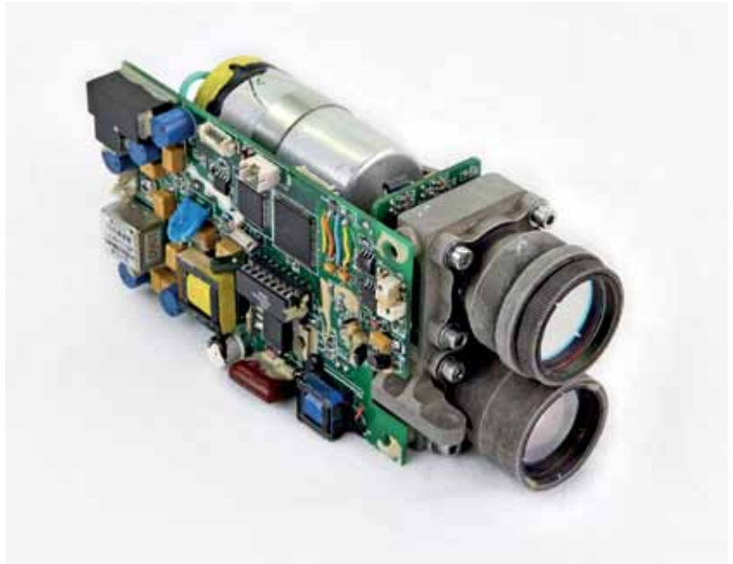
Рис.2. Серия дальномера LRF-ES на безопасной для глаз длине волны Fig.2. Rangefinder LRF-ES series on an eye-safe wave length
