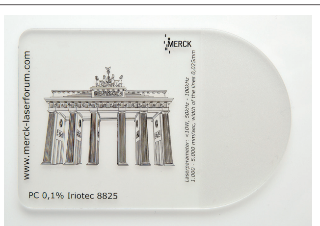
Рис.3. Прозрачность поликарбоната сохраняется Fig. 3. The transparency of the polycarbonate is retained [copyright: Merck KGaA, Darmstadt, Germany]
