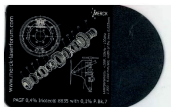
Рис. 6. Образец полимера с 0.4%-ным содержанием добавки Iriotec® 8835, 0.1% содержанием P. Bk. 7 в полиамиде с 30%-ным содержанием стекловолокна
