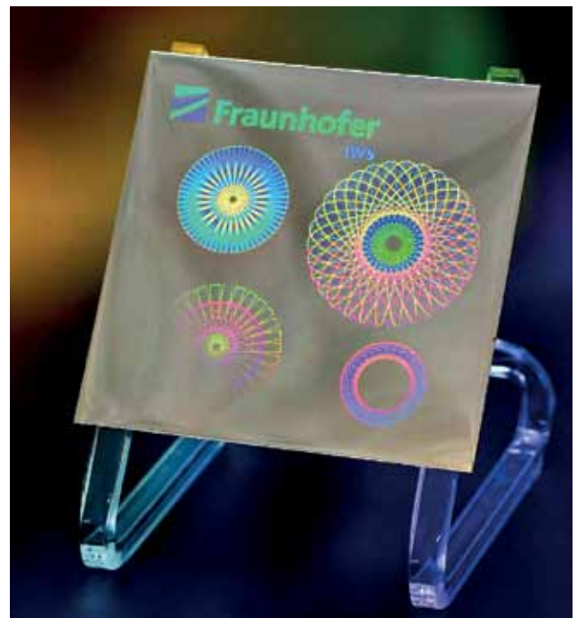
Рис.4. Никелевая пластина, структурированная наносекундным 1-мкм лазером
