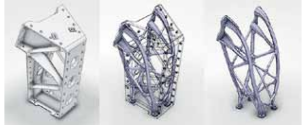
Рис.4. Облегчение конструкции детали британского спутника E3000 на 35% при повышении прочности на 40% за счет перераспределения нагрузки на новые ребра жесткости
