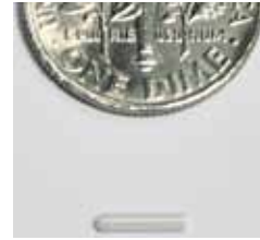
Рис.4. Наконечник для имплантации оптического волокна в головной мозг
