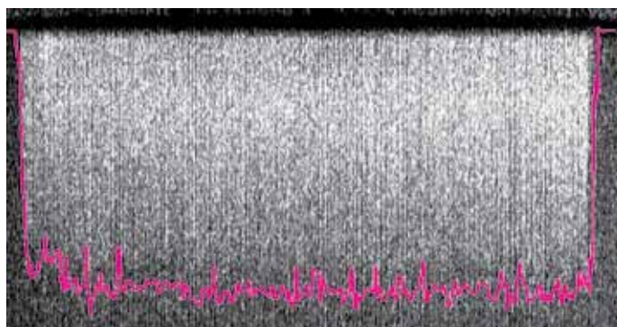
Рис.3. Рентгеновский снимок канала проплавления с наложенным сигналом с датчика глубины проплавления (выполнено в Штутгартском университете)
