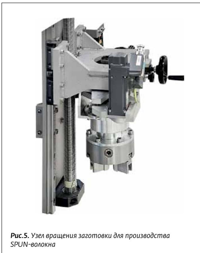
Рис.5. Узел вращения заготовки для производства SPUN-волокна
