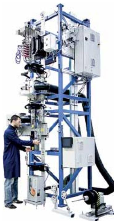
Рис.1. Башня вытяжки для производства специального волокна OFC 20SF
