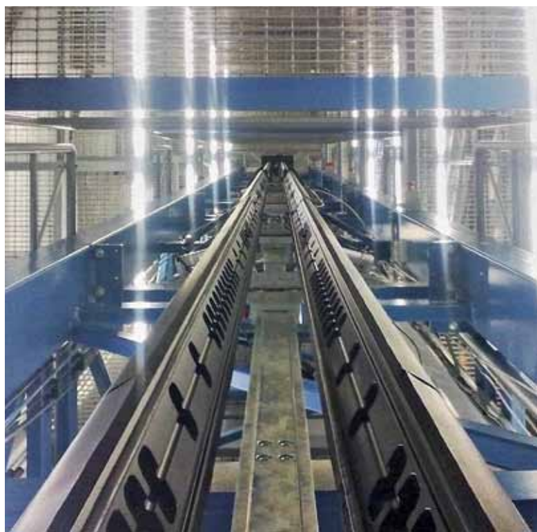
Рис.6. Камера охлаждения волокна с системой рекуперации гелия
