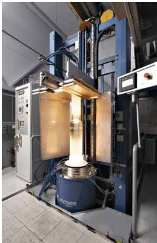
Рис.3. Башня для вытяжки специального волокна OFC 20SF (справа)
