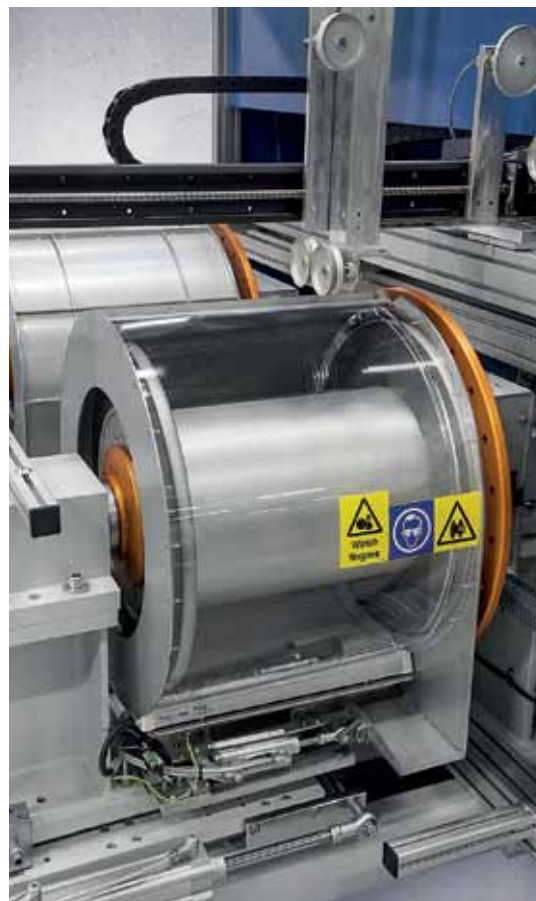
Рис.5. Сдвоенные приемные катушки DFT2500
