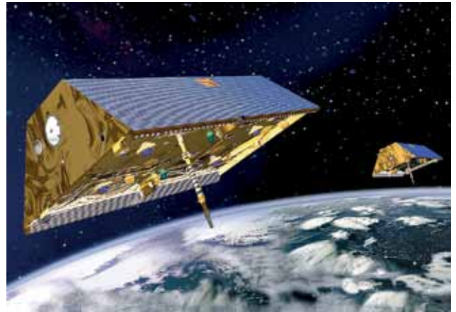
Рис.6. Модернизированная система GRACE-FO будет состоять из двух орбитальных спутников, работающих как одна система (как и система GRACE1)
