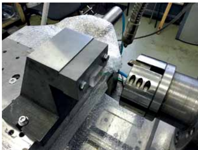
Рис.5. Зона резания при алмазном фрезеровании дигидрофосфата калия
