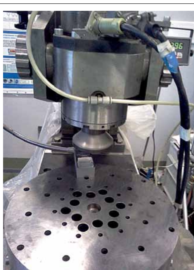
Рис.6. Настройка специального экспериментального стенда при алмазном шлифовании сапфира Fig. 6. Setting up of the special experimental stand for diamond grinding of sapphire
