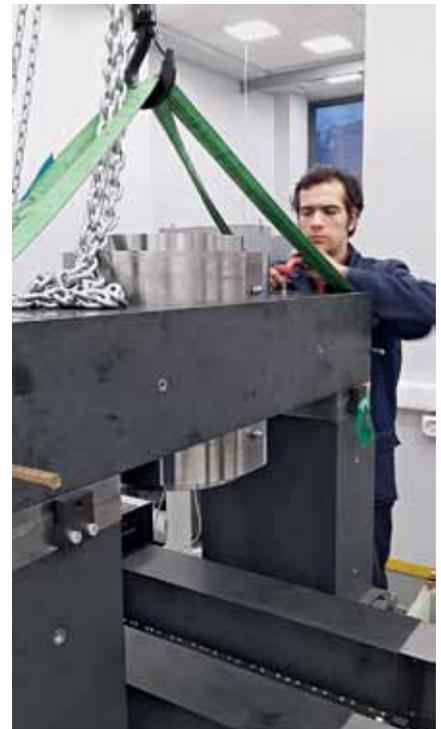
Процесс сборки ультрапрецизионного станка
