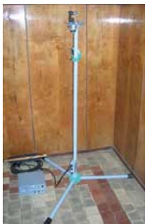
**Рис.5.** Лазерная установка с полупроводниковым лазером для обработки семян и растений
