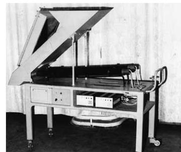
**Рис.1.** Лазерная установка с наклонным желобом
