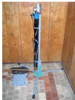
**Рис.4.** Лазерная установка ЛУ-2 для обработки семян и растений
