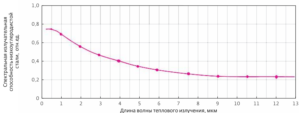
Рис.1. Зависимость спектральной излучательной способности \epsilon(\lambda) низколегированной стали от длины волны излучения \lambda Fig. 1. Dependence of the spectral radiation capacity \epsilon(\lambda) of low-alloy steel on the wavelength \lambda
