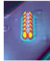
Рис.3. СТМ-изображение 12 атомов железа, собранных на атомном уровне в антиферромагнетик
