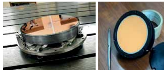
Рис.7. Деформируемые зеркала с диаметрами 80–180 мм и числом элементов управления N=19-61
