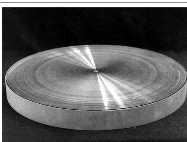
Рис.9. Зонная пластина, диаметр 500 мм, фокусное расстояние 12 м для рабочей длины волны 633 нм (изготовлена на делительной машине МДГ-500; ГИПО, 1993)
