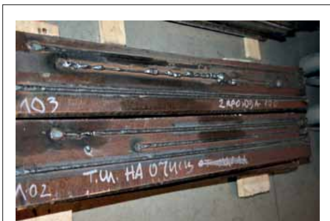
Рис.3. Лазерная очистка стальной пластины от ржавчины, крошек окалины и масла с последующей наплавкой Fig.3. Steel plate laser cleaning of corrosion, scale chips and oil with the further facing
