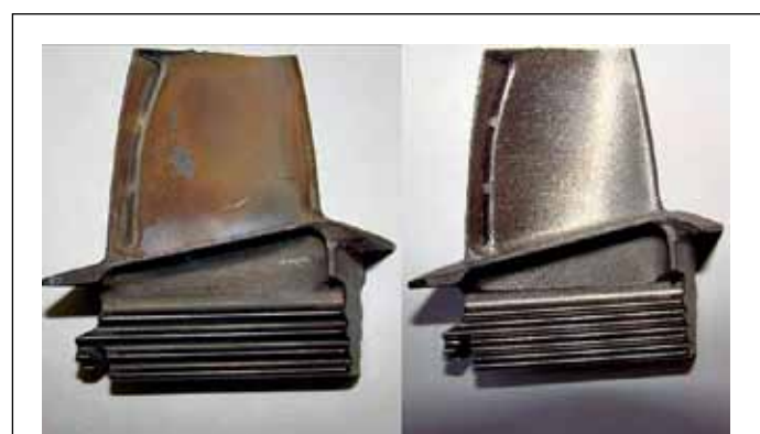
Рис.4. Лазерная очистка турбинной лопатки от эксплуатационных загрязнений при помощи импульсного волоконного лазера Fig.4. Turbine blade laser cleaning of consumption pollutants using the pulse fiber laser
