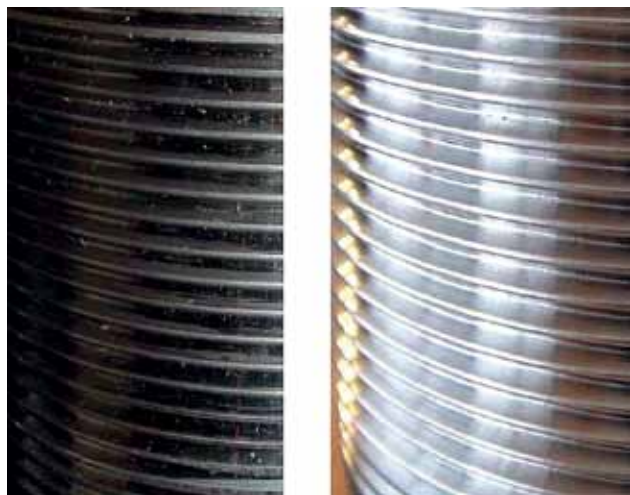
Рис.5. Лазерная очистка поверхности резьб трубы. Слева резьба до лазерной, справа после лазерной очистки Fig.5. Laser cleaning of the surface of pipe thread. Thread before laser cleaning – on the left, thread after laser cleaning – on the right
