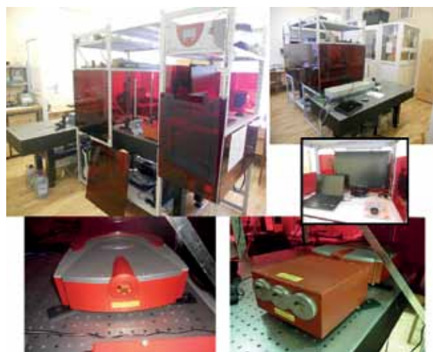
Рис.2. Волоконная фемтосекундная лазерная система (Satsuma, Amplitude Systemes): сверху – на оптическом столе с оптическим защитным экраном, в середине справа – компьютерное управление лазером, внизу слева – блок из усилителя, компрессора и акустооптического модулятора; внизу справа – генератор высших гармоник Fig. 2 Fiber femtosecond laser system (Satsuma, Amplitude Systemes): on the top – on optical table with optical protective screen; in the center, on the right – computer control of laser; at the bottom, on the left – unit consisting of amplifier, compressor and acoustic-optical modulator; at the bottom, on the right – generator of higher harmonics.
