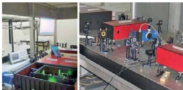
Рис.1. Фемтосекундная лазерная система на базе титан-сапфировой активной среды Старт-248 М, Авеста-Проект: слева – трехмодульная титан-сапфировая фемтосекундная лазерная система из генератора и стретчера импульсов (на переднем плане), регенеративного и многопроходового усилителя (в центре), компрессора импульсов (вдали); справа – генератор второй и третьей гармоник на выходе компрессора (вдали) с компактным спектрометром для контроля спектров гармоник (в центре) и автокоррелятора (на переднем плане) Fig. 1 Femtosecond laser system based on titanium-sapphire active medium Start-248 M, Avesta-Project: on the left – three-unit titanium-sapphire femtosecond laser system consisting of generator and stretcher of pulses (on the front), regenerative and multiple-line amplifier (in the center), pulse compressor (far off); on the right – generator of the second and third harmonics at the compressor discharge (far off) with compact spectrometer for the control of harmonic spectrums (in the center) and autocorrelator (on the front).
