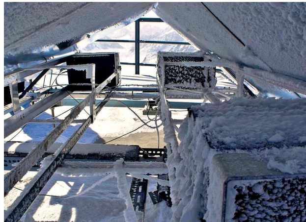
Рис.1. Прототип детектора, установленного в обсерватории Сфинкс для тестирования методики определения траектории движения частиц (восходящие/нисходящие) и для исследования работы детектора в суровых климатических условиях Fig. 1. Prototype detector installed at Sphinx (HFSJG) to test upward/downward particles separation and environmental effects
