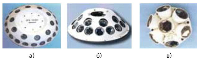
Рис.1. Ретрорефлекторные системы для низкоорбитальных спутников: а) – ГЕО-ИК; б) – Метеор; в) – CruoSat-2 Figure 1. Retroreflector arrays for low-orbit satellites: а) GEOIK; б) Meteor; в) CruoSat 2
