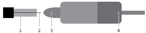
Рис.3. Схема установки для формовки: 1 – катод; 2 – эмиттирующая часть катода; 3 – холодноплазменный разряд; 4 – трубка коагулятора
